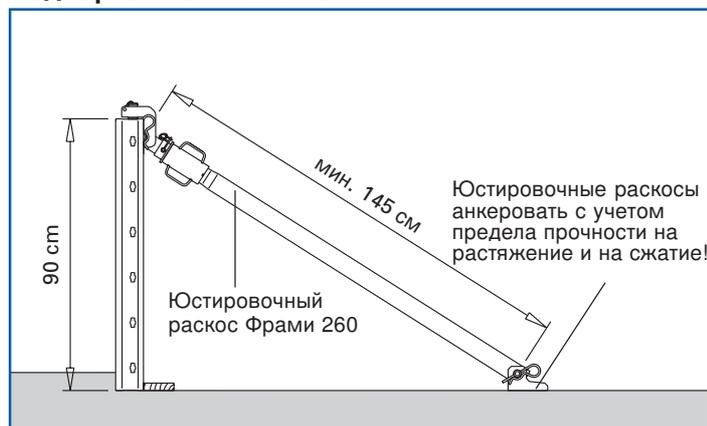
Юстировочные раскосы обеспечивают безопасную установку и рихтовку рамных элементов Фрамы.
