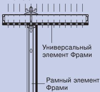
Для прямых углов применяется **универсальный элемент Фрамы**, который делает возможной быструю подгонку с шагом 5 см до толщины стен 45 см.
