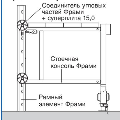
Например, при формировании углов с универсальными элементами или же на выступах опалубки - для того, чтобы создать возможность образования покрытия до конца опалубки.
