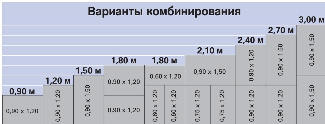
Идеальная модульная сетка элементов позволяет создавать и другие варианты комбинирования по **ширине** и **высоте** с **интервалом в 15 см**.
