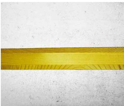
Geringe Verformung und reduzierte Rissbildung durch symmetrischen Plattenaufbau mit gleichstarken und speziell ausgerichteten Decklagen
