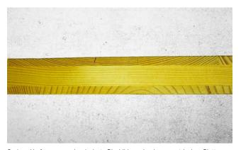
Geringe Verformung und reduzierte Rissbildung durch symmetrischen Plattenaufbau mit gleichstarken und speziell ausgerichteten Decklagen
