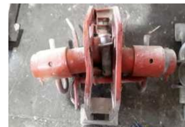
Deformované spojovacie prvky
