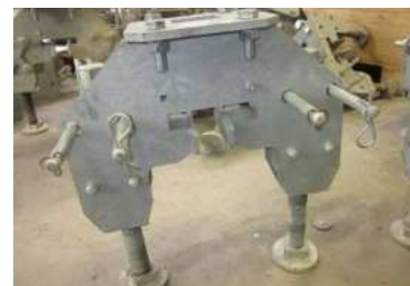
✓ Nedeformované spojovacie časti, kovové konzoly, závitové časti, skrutky a klíny
