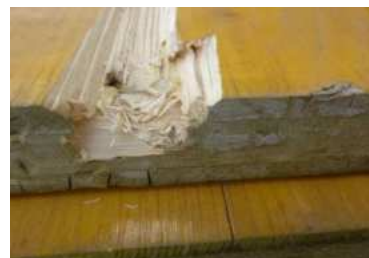
Otvory po klincoch s priemerom > 4mm v drevených materiáloch
